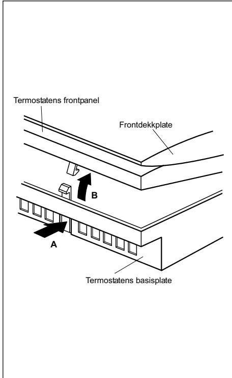
Hullene på basisplaten som er beregnet for festing av termostaten, har samme mål som de elektriske boksene som finnes på markedet.
