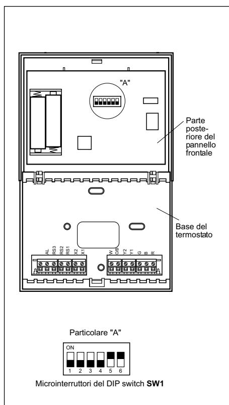
Con i microinterruttori del DIP switch SW1 si configurano i seguenti parametri:
