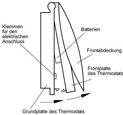
Sollte das Anschlusskabel nicht über eine Verteilerdose zugeleitet werden, muss der Thermostat mit den beiliegenden Dübeln und Schrauben an der Wand befestigt werden.
