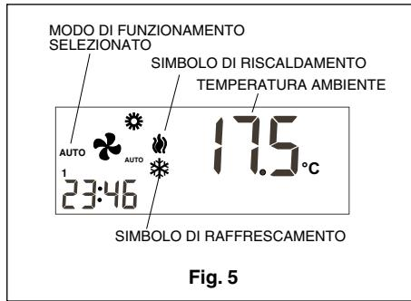
Trascorsi alcuni minuti, il sistema si avvierà, passando automaticamente al modo riscaldamento o raffrescamento per mantenere la temperatura ambiente nei limiti selezionati. Sul display, diventerà intermittente il simbolo corrispondente al modo in cui l'apparecchio sta funzionando in quel momento (riscaldamento o raffrescamento).
