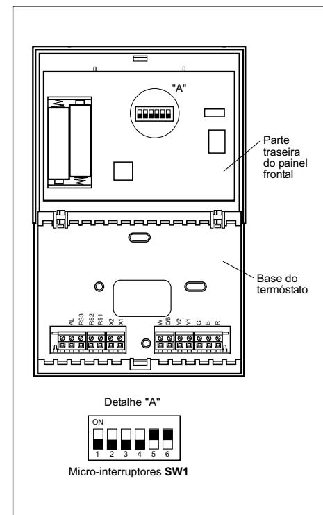
Mediante os micro-interruptores SW1, configuram-se os seguintes parâmetros:
