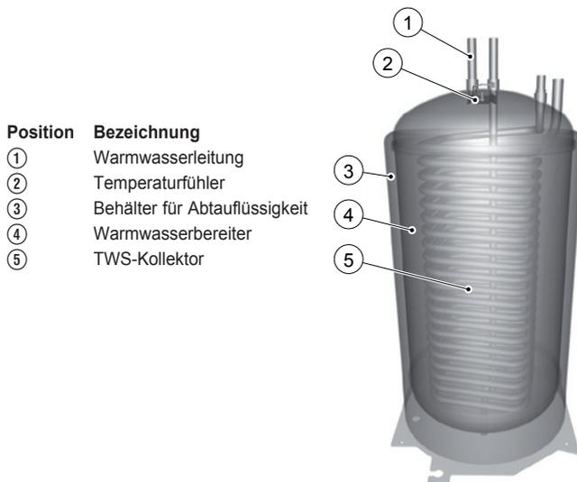
Abbildung 5: Warmwasserbereiter im Geysir Air.
