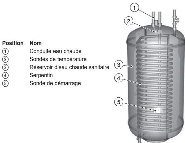
Figure 4: Réservoir d'eau chaude, Geysir et Geysir with Passive cooling.
